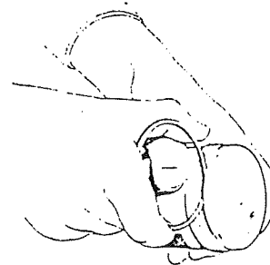
Bild 15. Kontroll av kolvringens passning mot styrstift.
